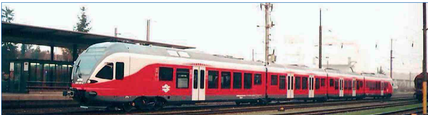
A MÁV számára épített első „FLIRT” típusú villamos motorvonat Basel St Johann állomáson, 2006. decemberében. A magyar fél kérésére a vonat egy áramnemű kivitelben készült.
