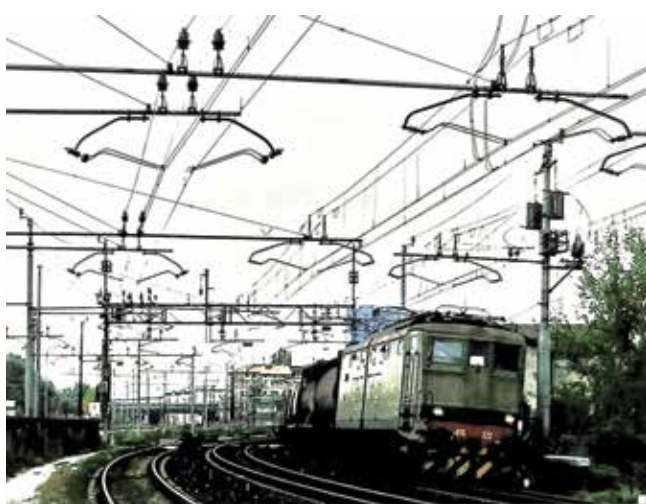
17. ábra. Látszólag három fázisú táplálás, de valójában már 3000V egyenáram.
