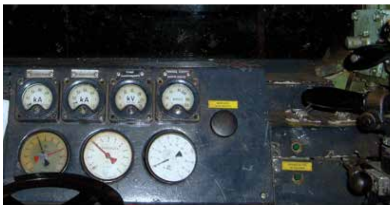
A 007-es Gigant igénytelenül átépített műszerfala, miután megjárta az Északi Főműhely szerelőcsarnokát.
